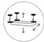
**Monitorización GNSS dinámica/estática (Bloques, estructuras).** Este tipo de monitorización se usa para el control de posicionamiento o verificación de desplazamiento de estructuras. Un ejemplo de este tipo de monitorización es el fondeo de cajones en obras marítimas o control de zonas con posibilidad de movimientos.
