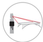
**Monitorización dinámica con Estación Total (Puentes, plataformas).** Este tipo de monitorización se usa para el control de posicionamiento de elementos móviles que deben ser ubicados en lugares concretos definidos en el proyecto. El empuje de puentes es un claro ejemplo de monitorización dinámica.
